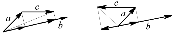
Рис. 6.9. Проекции суммы векторов
